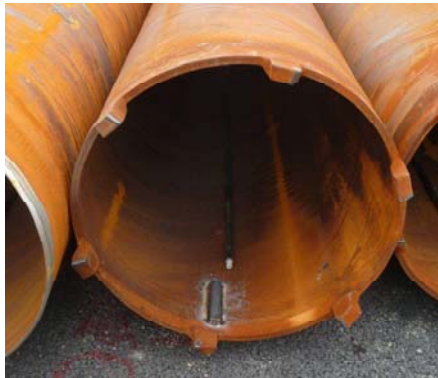
本設用鋼管杭
